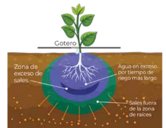
Figura 20. Lavado de sales mediante el riego.
