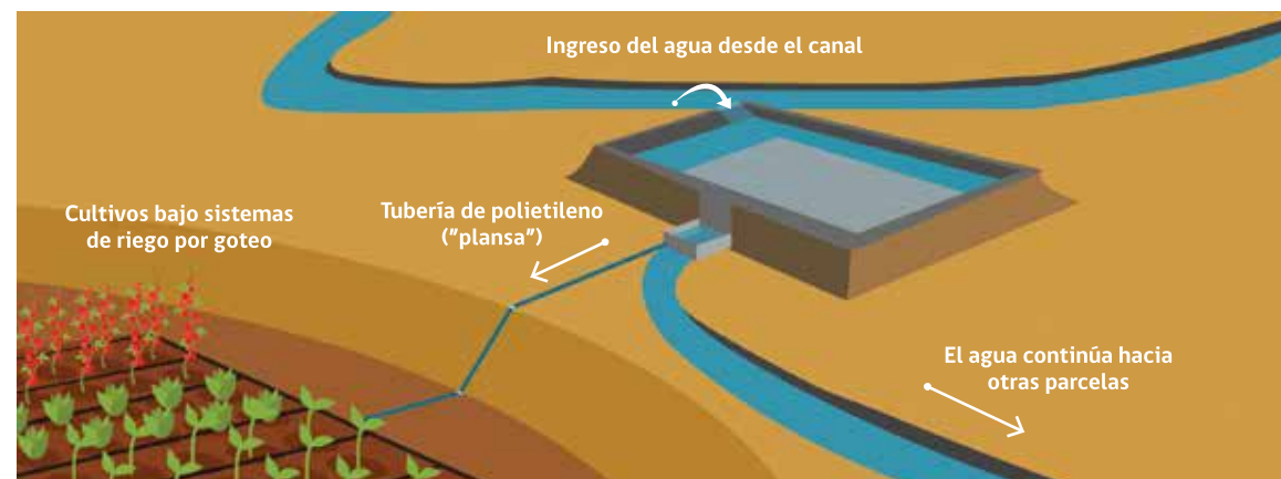
Figura 33. Riego por goteo con presión otorgada por el desnivel entre el estanque y sector de cultivos.
