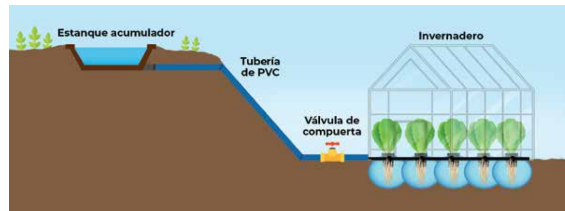
Figura 1. Se puede aprovechar el desnivel para otorgar presión a la red de riego por goteo en el invernadero.
