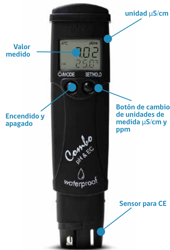
Figura 87. Detalle de información en pantalla y botones en un conductímetro.
