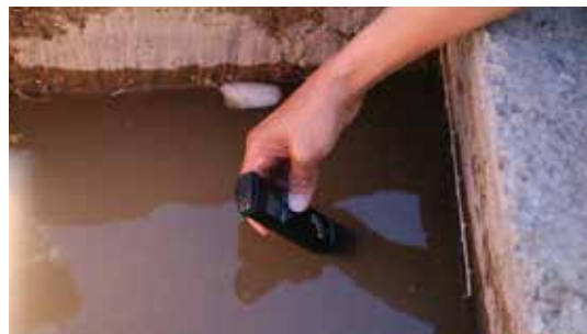
Figura 88. Control de la conductividad eléctrica (CE) en aguas superficiales (Chiu-Chiu).
