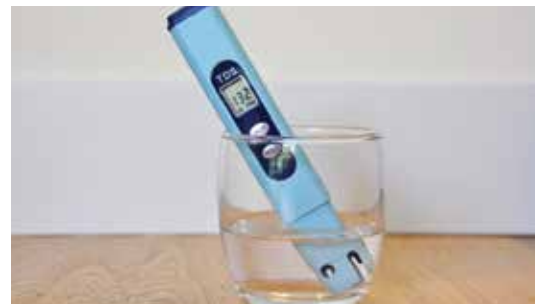
Figura 89. Conductímetro en agua de riego, dispositivo para medir conductividad eléctrica (CE).
