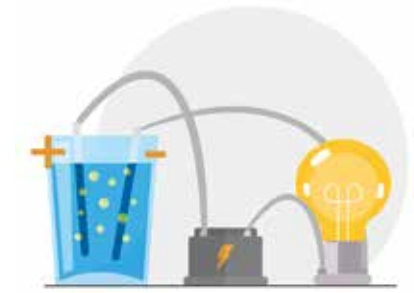
Figura 86. Esquema explicativo de la conductividad eléctrica (CE). A mayor concentración de sales en el agua, mayor facilidad para conducir la electricidad y mayor el valor de la conductividad eléctrica.
